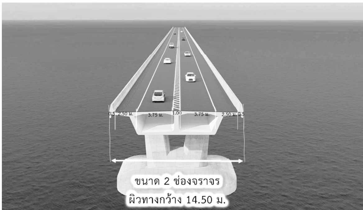
รูปที่ 8-3 แนวคิดรูปตัดโครงสร้างสะพานแบบ 2 ช่องจราจร โครงสร้างสะพานกว้าง 14.50 ม.
